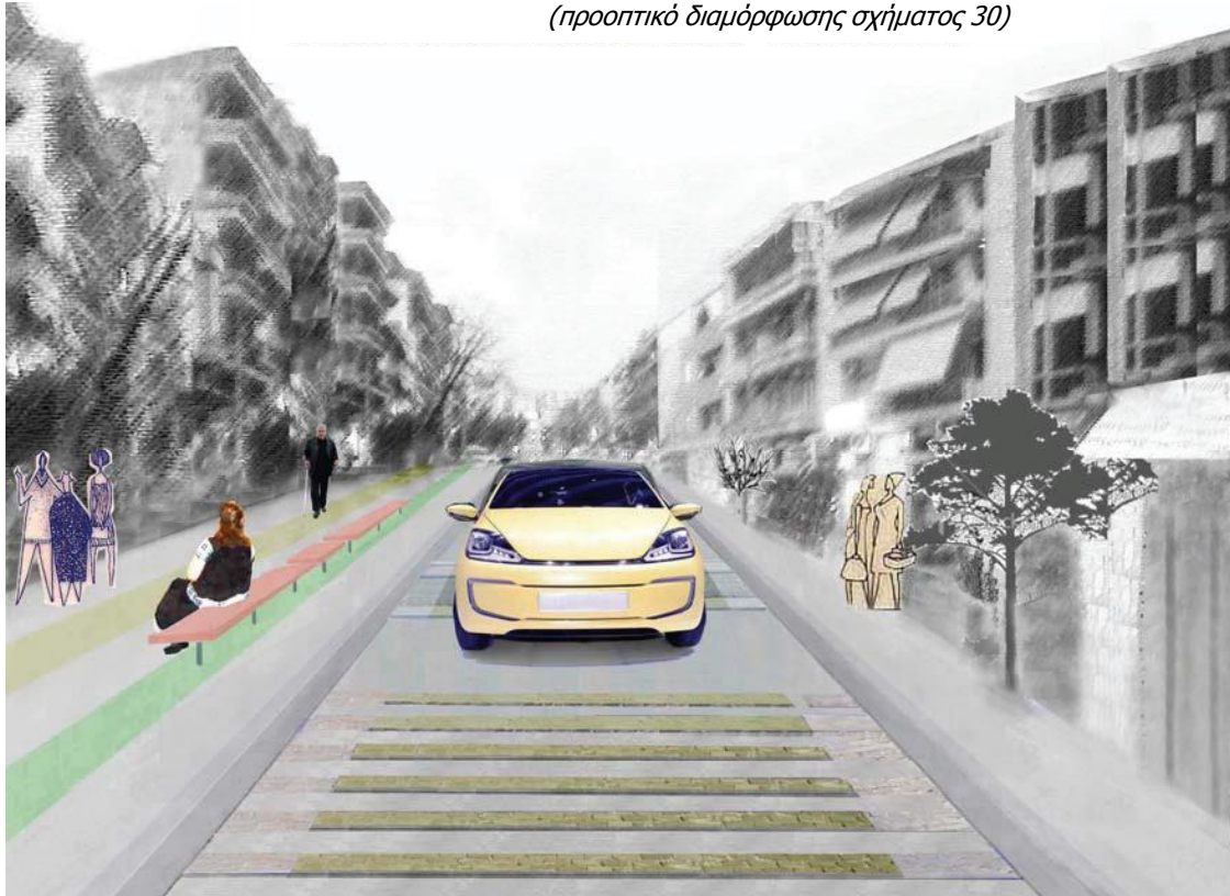
Σχήμα 32: Θορυβώδεις λωρίδες τμήμα Β (προοπτικό διαμόρφωσης σχήματος 30)
