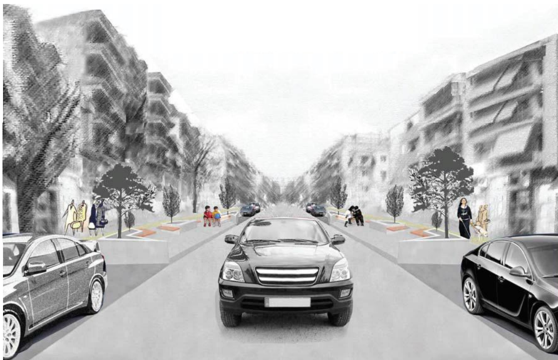
Σχήμα 19: Σημείο συμπίεσης (κυκλοφοριακός λαιμός) εναλλακτική πρόταση γ (διαμόρφωση με καθιστικά – σύνθεση 3) (προοπτικό διαμόρφωσης σχήματος 18)
