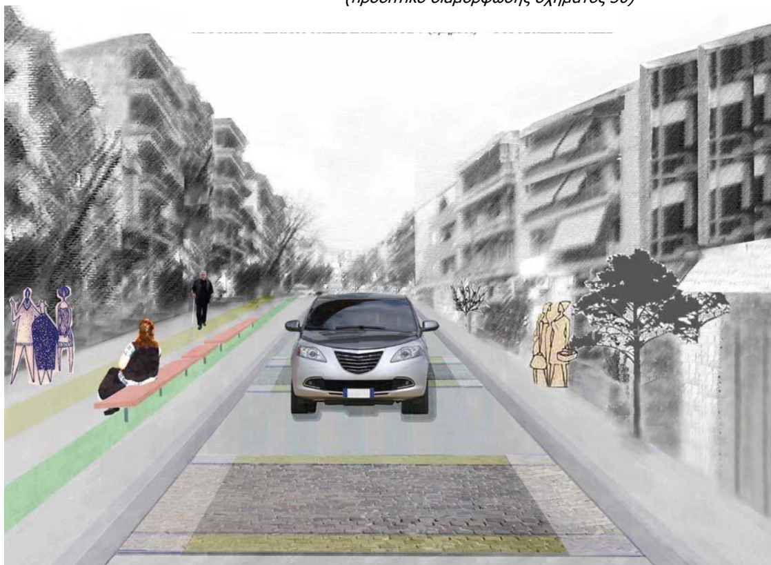
Σχήμα 31: Θορυβώδεις λωρίδες τμήμα Α (προοπτικό διαμόρφωσης σχήματος 30)
