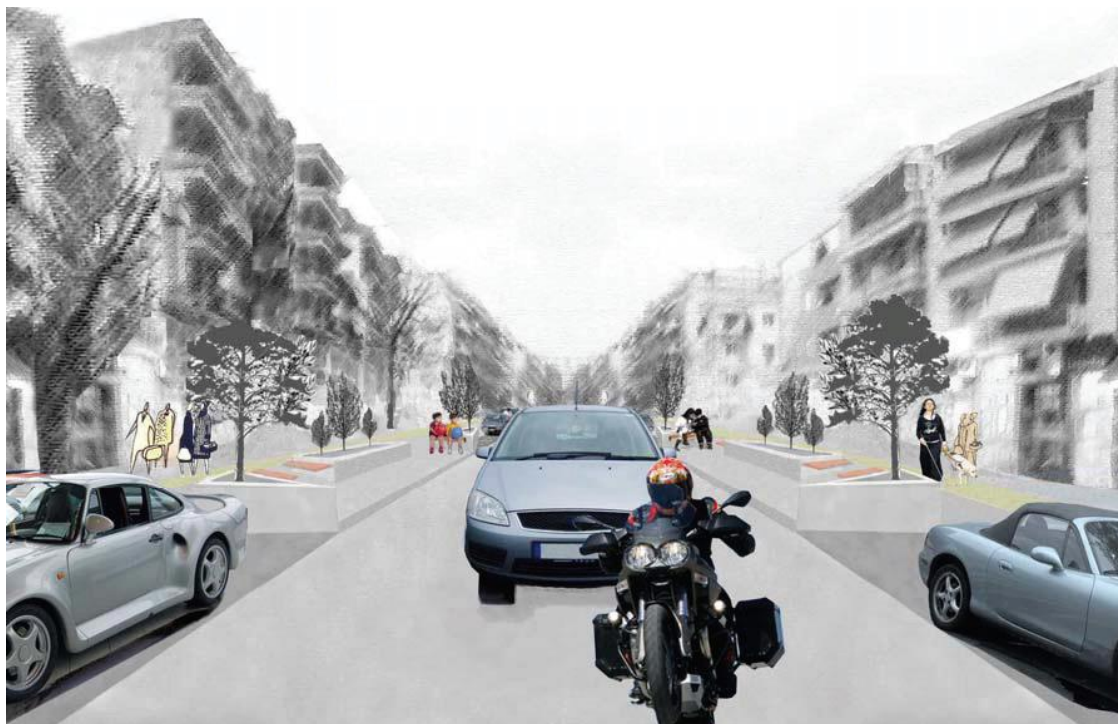
Σχήμα 17: Σημείο συμπίεσης (κυκλοφοριακός λαιμός) εναλλακτική πρόταση β (διαμόρφωση με καθιστικά – σύνθεση 2) (προοπτικό διαμόρφωσης σχήματος 16)
