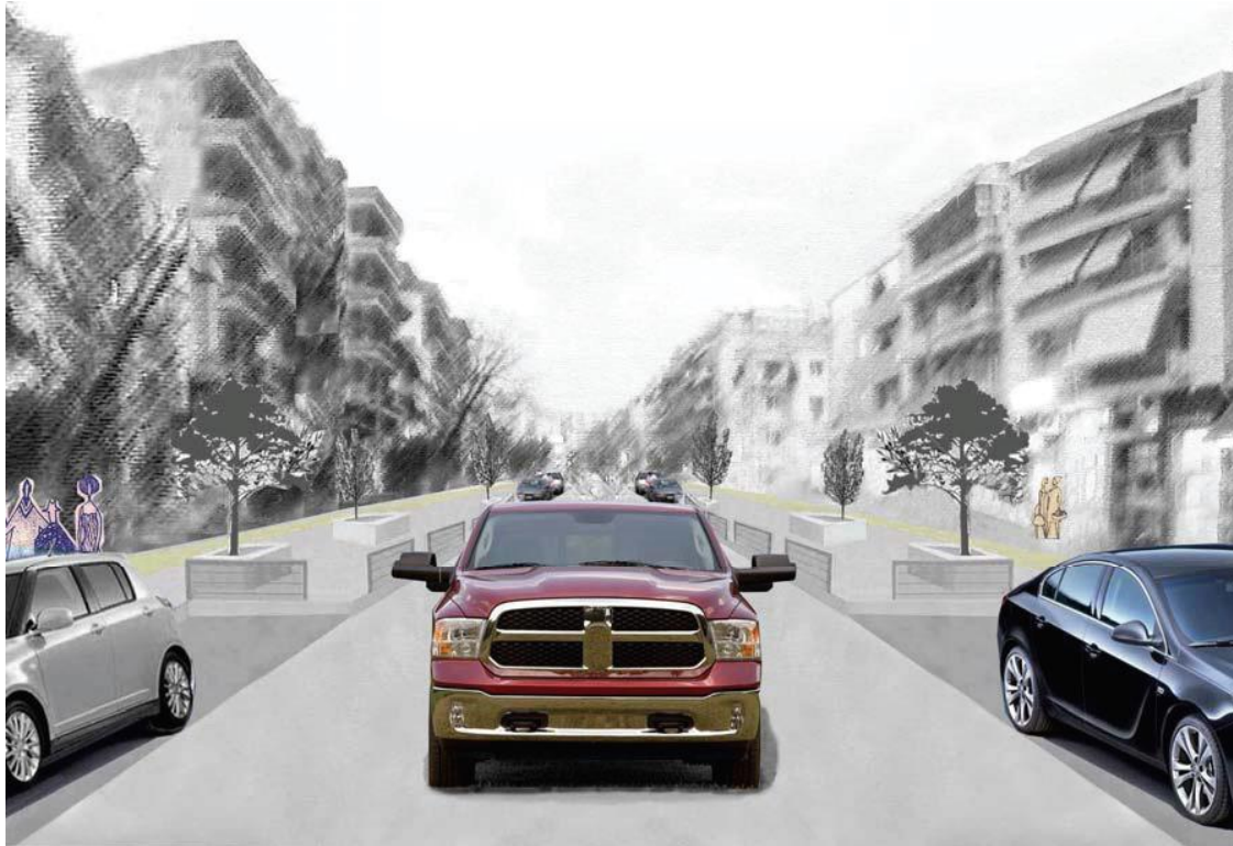
Σχήμα 21: Σημείο συμπίεσης (κυκλοφοριακός λαιμός) εναλλακτική πρόταση δ (απλή διαμόρφωση) (προοπτικό διαμόρφωσης σχήματος 20)
